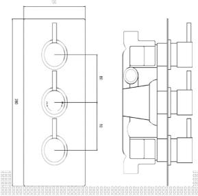
HP1 - 1 bar min HP2 - 2 bar min
